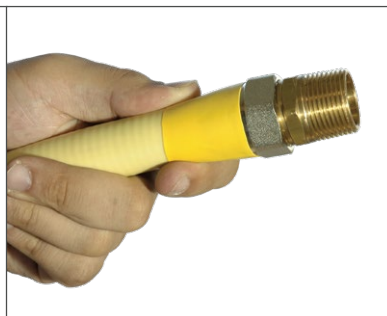
7. Prije spajanja prekrijte namotaje crijeva termo skupljajućom tubom da biste zaštitili crijevo od korozije.
