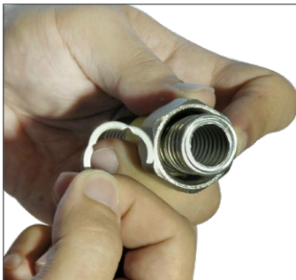
5. Postavite steznu podlošku oko nabora.
