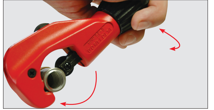
Kesme işlemi için aparatı hortum etrafında döndürme
