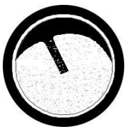
图 C/冷凝水积聚 如果流量指示器完全被水浸没，则说明观视镜安装位置过于靠近系统，并且在设备中存在伴随热传递发生的冷凝水积聚。由此导致蒸汽疏水阀容量不足。
