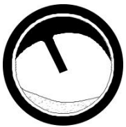
图 D/蒸汽泄漏 通过的蒸汽明显积压于水面上。蒸汽填满导流板和水面之间的区域。这意味着，蒸汽疏水阀正在泄漏蒸汽。
